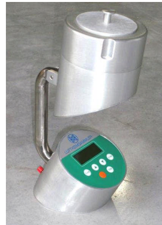
Luftkeimsammler für Petrischalen für die Luftproben
